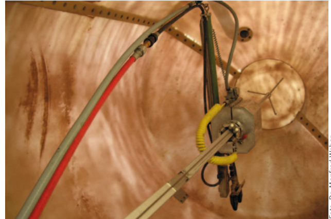
Bild 9: Innere Reinigungsdüse des Reinigungsroboters
